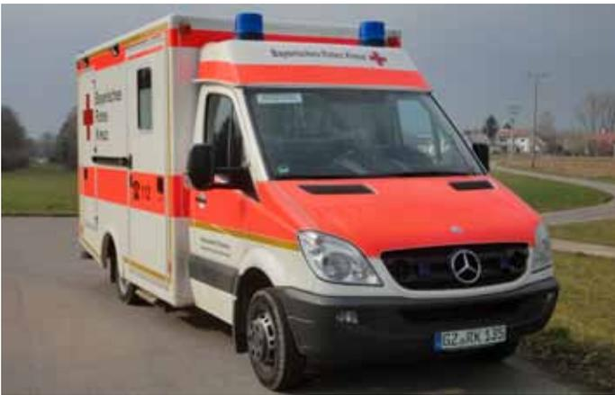
Der Mercedes Benz Sprinter 516CDI mit Wietmarscher-Aufbau, fünf Sitzplätzen und einem Liegeplatz (Motorisierung: 4 Zylinder Diesel, 163 PS)
